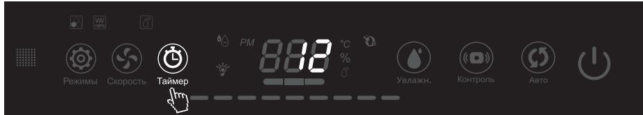
Примечание 1: Нажмите кнопку «Таймер» на панели управления для предварительного просмотра времени настройки.
